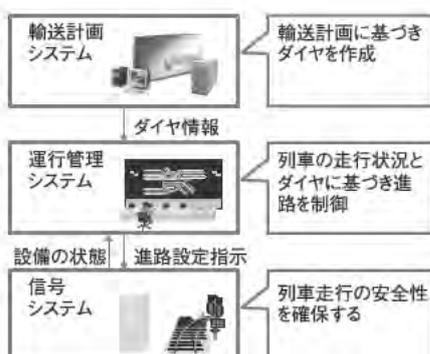
図 4.1 輸送系システムの構成
